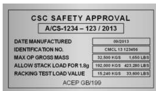
Figura 8.2 Placa de aprobación relativa a la seguridad CSC con la marca ACEP
