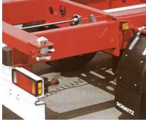
Figura 2.1 Cerrojo giratorio en un vehículo de carretera
