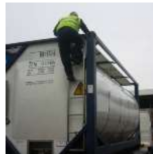
Figura 8.7 Paso de la escalera a la pasarela
