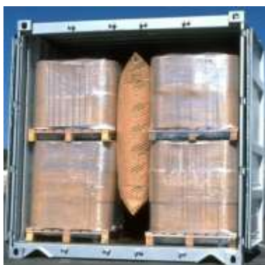
Figura 7.9 Espacio llenado con una bolsa de aire para estiba central
