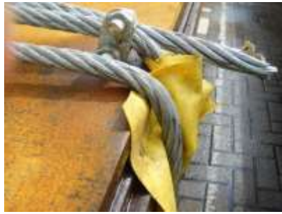
Figura 7.11 Protección de bordes deficiente
