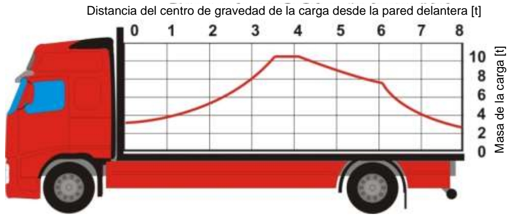
Figura 7.22 Ejemplo de un diagrama de distribución de la carga de un camión rígido
