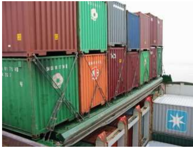
Figura 2.2 Guías de estructuras celulares y barras de trinca en un portacontenedores
