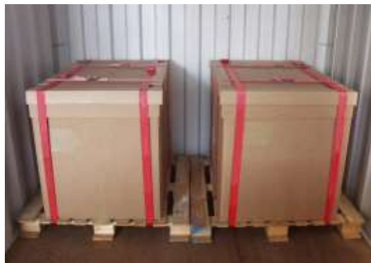
Figura 7.8 Carga firmemente fijada a paletas con trincas de tela
