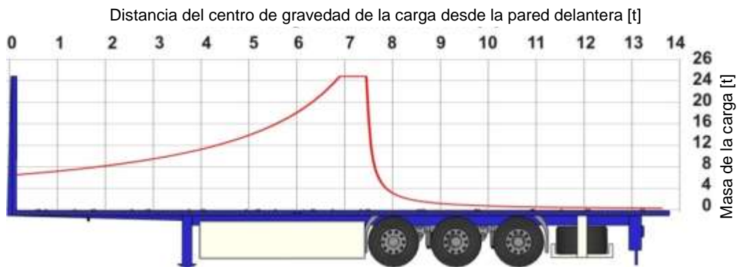
Figura 7.23 Ejemplo de un diagrama de distribución de la carga de un semirremolque
