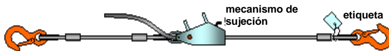
Figura 7.16 Trinca metálica normalizada utilizada en el transporte por carretera con mecanismo de sujeción
