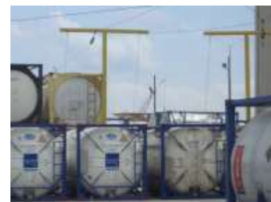
Figura 8.12 Soportes para detener las caídas
