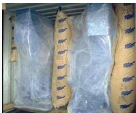
Figura 7.10 Bultos de configuración irregular bloqueados con bolsas de aire para estiba
