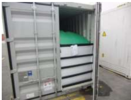
Figura 7.51 Contenedor provisto de un flexitanque Figura 7.52 Etiqueta de advertencia del flexitanque
